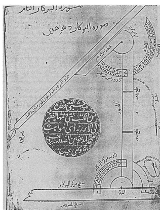
Figura 2: Instrumento para la construcción de cónicas.
